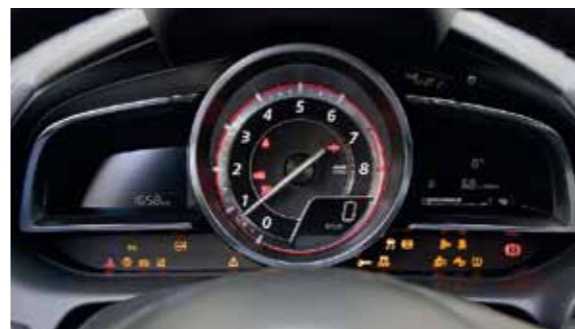
Dvojka nabídla dvě varianty přístrojové desky. Vlevo je varianta s digitálním rychloměrem, jež byla standardem u vrcholné verze. Vpravo je varianta s analogovým rychloměrem. Teploměr chladicí kapaliny vždy chybí. Částečně jej nahrazuje kontrolka ohřívání motoru.
