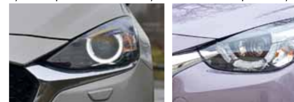
Do modernizace se nabízely dvě verze předních světlometů. Většina aut na trhu má standardní se staříčkou žárovkou H4. Uprostřed je vyšší verze plně diodových svítilen, které mohly být dokonce adaptivní. Vlevo je světlomet LED od modernizace v roce 2019. Spolu s tím došlo k vypuštění svítilen s žárovkou H4 z nabídky.
