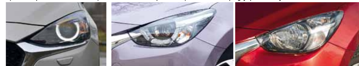
Do modernizace se nabízely dvě verze předních světlometů. Většina aut na trhu má standardně se staričkou žárovkou H4. Uprostřed je vyšší verze plně didadových svítlen, které mohly být dokonce adaptivní. Vlevo je světlomet LED od modernizace v roce 2019. Spolu s tím došlo k vypuštění svítlen s žárovkou H4 z nabídky.
