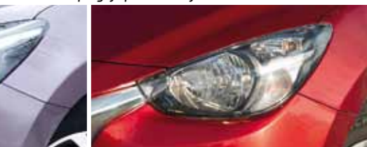
Do modernizace se nabízely dvě verze předních světlometů. Většina aut na trhu má standardní se staříčkou žárovkou H4. Uprostřed je vyšší verze plně diodových svítilen, které mohly být dokonce adaptivní. Vlevo je světlomet LED od modernizace v roce 2019. Spolu s tím došlo k vypuštění svítilen s žárovkou H4 z nabídky.
