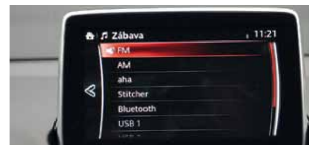
Integrovaný infotainment nabídl výrobce ve dvou verzích. Vlevo je vyšší varianta s navigací. Vpravo základní s monochromatickým displejem. I ta ale má slot na USB 2.0 a aux. Od roku 2019 je ve výbavě nové rozhraní, které podporuje také Apple CarPlay a Android Auto. Vyšší verze potěší ovládáním otočným kolečkem za řadicí pákou. Dotyková obrazovka funguje pouze u stojícího vozidla.
