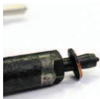
Jen málokdo by hádal, že droboučké těsnění vstříkovače dokáže zcela zničit motor
