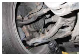
Do předního ramene někdo bez zajištění nalisoval nový čep, což je trochu o ústa
