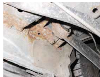
Korozí napadá i důležitá místa uchycení podvozku, nepadcejte prevenci
