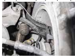
Prostřední příčné rameno vpředu je na výměně. Nad ním najdeme ještě jedno.
