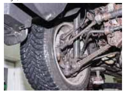
Pětiprvková náprava vzadu drží vzorně, vůli jsme našli jen v kostech stabilizátoru
