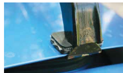
Na rez si lze zadělat i špatnou montáží zahrádky na víko kufru. Je citlivá na přesnost a na zárubeň by měly přijít ochranné fólie.
