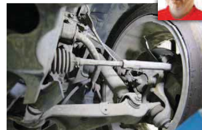
Složitá a kompletně hliníková náprava vydrží překvapivě dost. Je dimenzovaná na těžší model RX-8.
