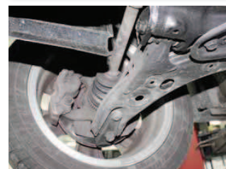
Ramena přední nápravy jsou originální a drahá. Čep i silentbloky lze měnit zvlášť.
