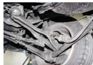
Zadní náprava známá jako TTL využívá tři ramena a tzv. Chapmanovy vzpěry
