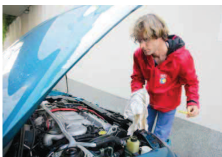
Pravidelná a hlavně častá kontrola hladiny oleje je pro šestiválce Mazdy série K životně důležitá
