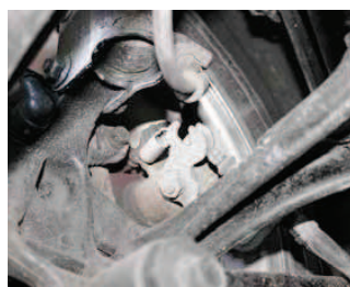
Zatuhlý zadní brzdíč poznáte podle nefunkční parkovací brzdy. Tady je v pořádku.
