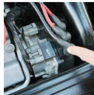
Zrada se ukrývá v rozdělovači. Pokud selže optický snímač pro nízké otáčky, s vozem neodjedete. Repasovaný rozdělovač vyjde na 5000 Kč.
