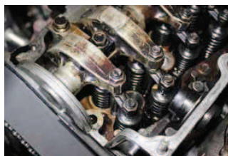
Po 80 000 km je třeba kontrolovat ventilovou vůli. To tady není úplně jednoduché.
