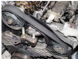
Rozvody 2.0 MZR-CD vyžadují pozornost po ujetí 120 000 km nebo šesti letech
