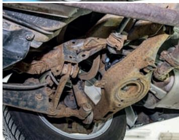
Podvozek je mechanicky odolný, vůle nejčastěji vznikají jen v uložení zadního podélného ramene, které lze vyměnit
