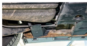
Auto zřejmě často parkovalo v trávě, vzliánající vlhkost se kromě podvozku podepsala i na podlaze
