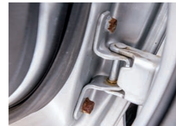
Protikorozní ochrana poněkud kolísala, je třeba ji hlídat na všech místech
