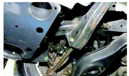
Přední čepy zatím nikdo nemusel měnit, kompletní rameno ovšem stojí osm a půl tisíce. Se zadní nápravou potíže nejsou, rez kolem svarů nápravnice je čas řešit.
