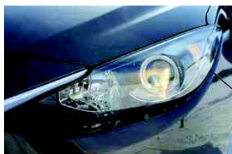
Halogenové potkávačky s čočkou svítí překvapivě slabě, napravuje to délka se samostatnou parabolou. Máte-li na výběr, hledejte zřejmě lepší xenon.
