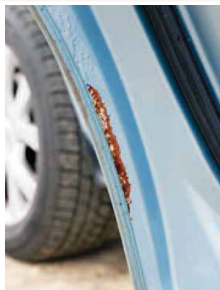
Každý svar na karoserie občas prohlédněte, takhle vypadá boční hrana dveří
