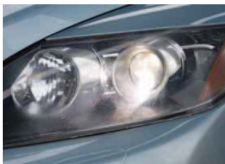
Slepnoucí čočky už pohlcovaly hodně xenonového světla, naštěstí jdou rozleštit
